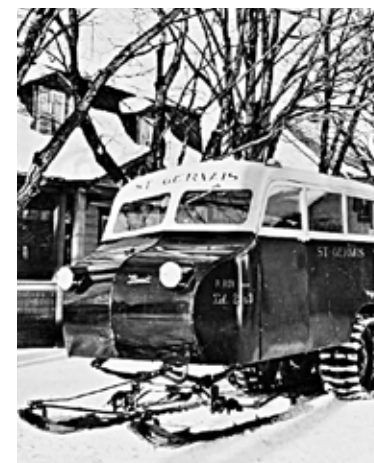
En 1945, Rolland Roy devant le fleuron de sa flotte de véhicules d'hiver, son autoneige Prévost de douze sièges et dotée d'un moteur V-8. Collection famille Roy.
